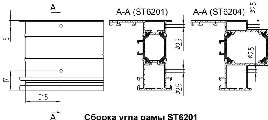
Сборка угла рамы ST6201
